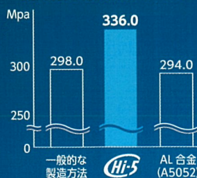
■基本物性 [ 機械的強度比較 ] 引張試験 (試験方法 JIS K 7161)
